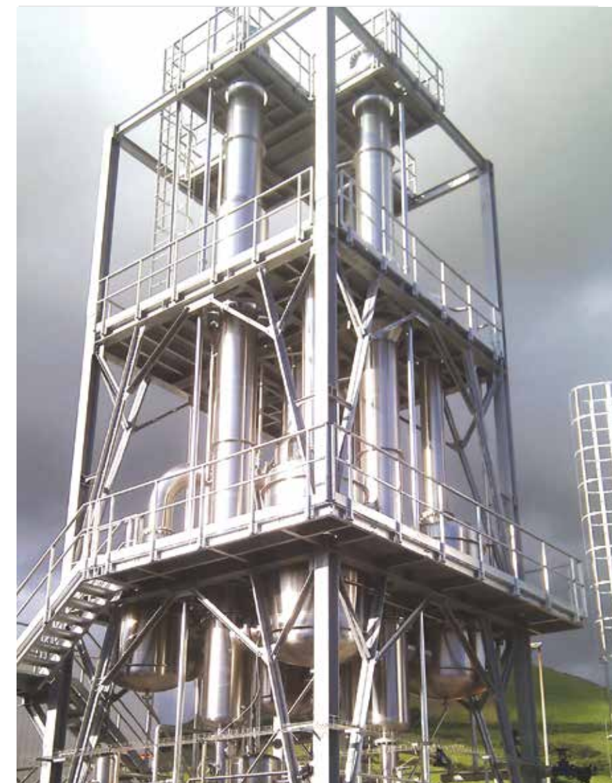
^ Испаритель с системой падающая пленка
